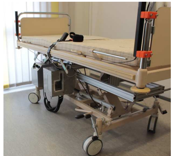
Patientensicherungssystem an Krankenhausbett montiert
